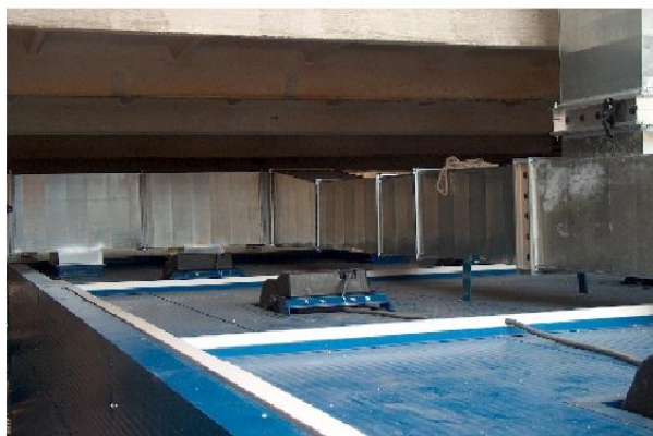
Rys. 5. Pełne oświetlenie komory śrutowniczej. Oświetlenie sufitowe.
