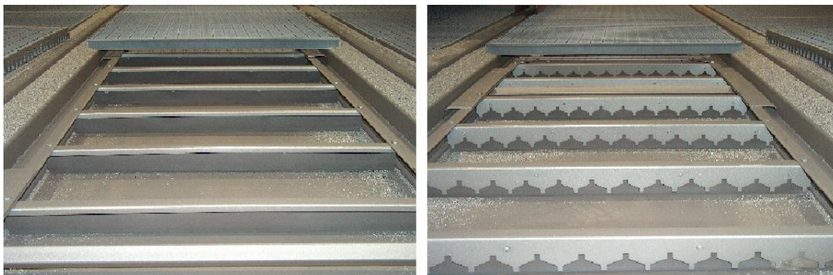
Rys. 8. Podłoga zgarniająca oraz podłoga zgarniająca uzbrojona listwami elastycznymi
