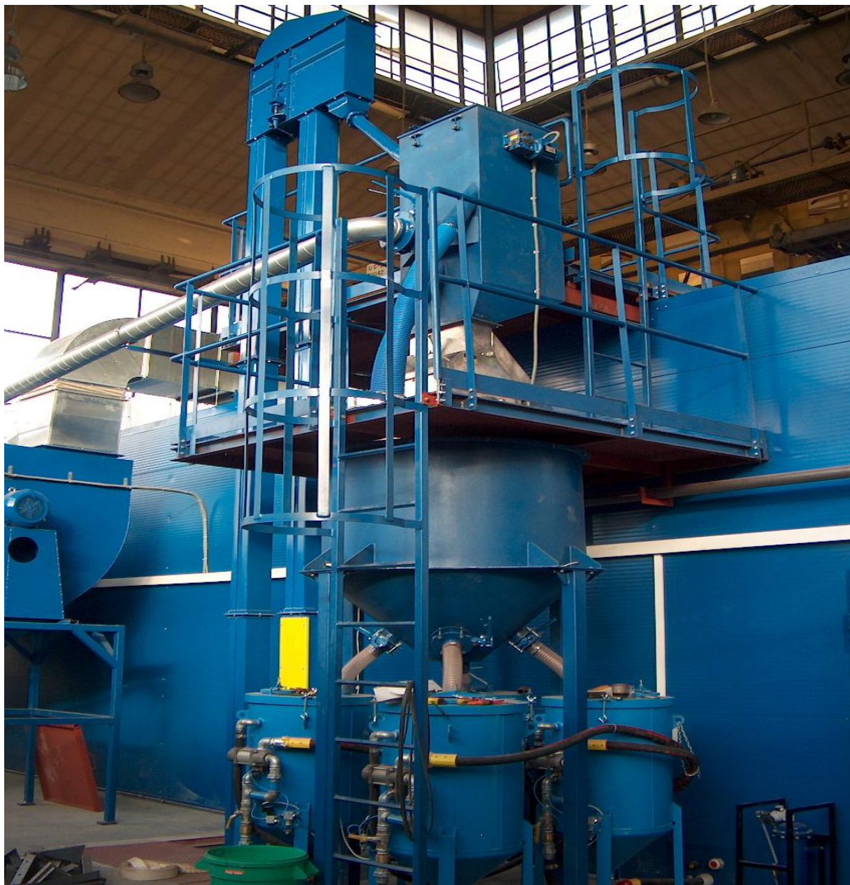
Rys. 11. Podnośnik kubekowy, separator ścierniwa, zbiornik zasypowy, oczyszczarki 200l.
