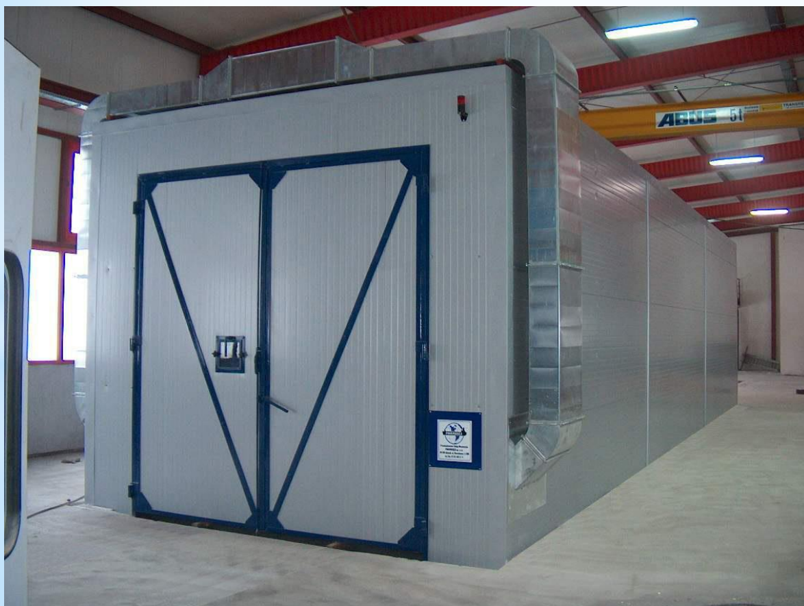
Komora śrutownicza jako obiekt wewnętrzny
